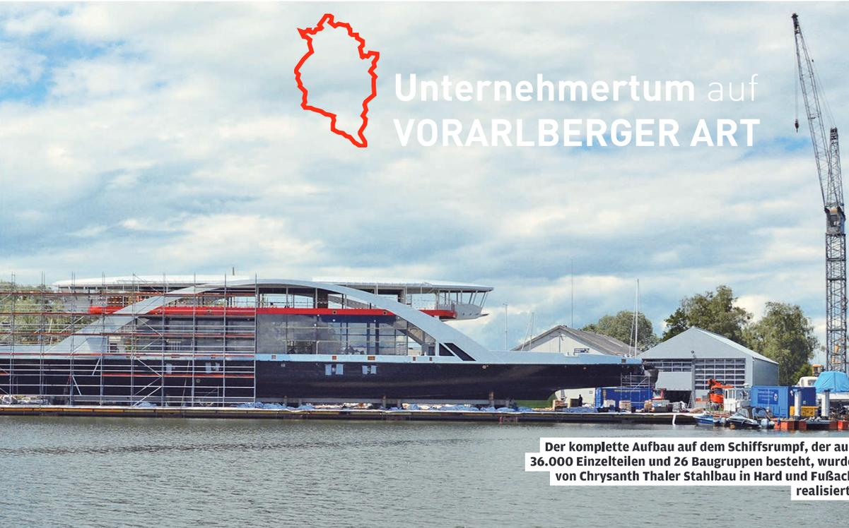
Der komplette Aufbau auf dem Schiffsrumpf, der aus 36.000 Einzelteilen und 26 Baugruppen besteht, wurde von Chrysanth Thaler Stahlbau in Hard und Fußsach realisiert.
